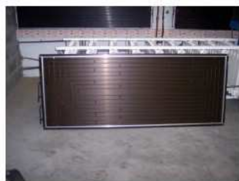
Kép a panel kerettel való megerősítéséről
